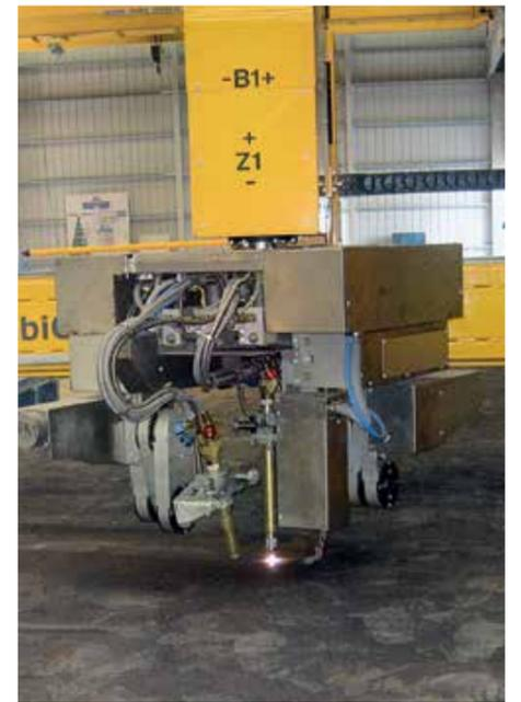
La CombiCut es robusta y de alta precisión, está diseñada especialmente para múltiples turnos de plasma de alto rendimiento y de corte por oxicorte. Permite el corte de acero de hasta 300 mm, corte en bisel con un par antorchas de oxicorte triples o Rotators de plasma, el corte simultáneo con más de 10 antorchas, perforar hasta 40mm Ø, corte de tubería y el procesamiento de la cúpulas o domos.
