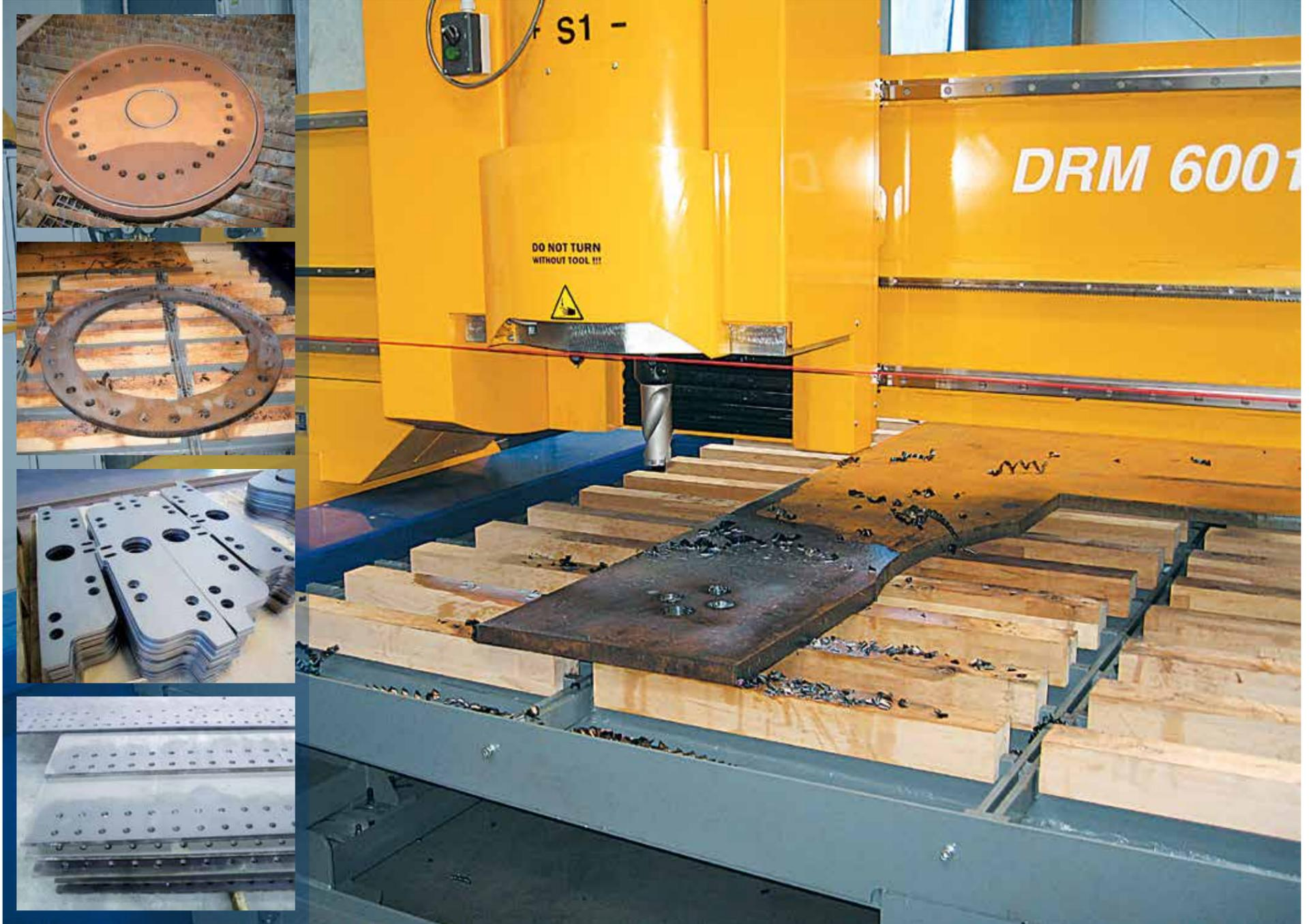
La máquina DRM-B está diseñada para el trabajo pesado de perforación CNC de planchas de construcción, planchas tubulares para intercambiadores de calor y otros trabajos de perforación exigentes. La máquina está equipada con una mesa de perforación especial con
