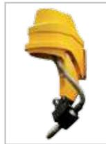
El cabezal de plasma de 5 ejes con rotación ilimitada permite el corte en bisel de todo tipo de geometrías, chapas, tubos y perfiles con una inclinación de hasta 50°. El soporte de la antorcha incluye sensores para la detección de desplazamiento de la antorcha, IHS y calibración automática.
