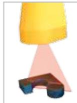
El escáner láser es muy útil para la digitalización de contornos rectos de las partes pre cortadas de una pieza, permite la localización de la misma para finalmente realizar el biselado con el sistema avanzado de ABP.
