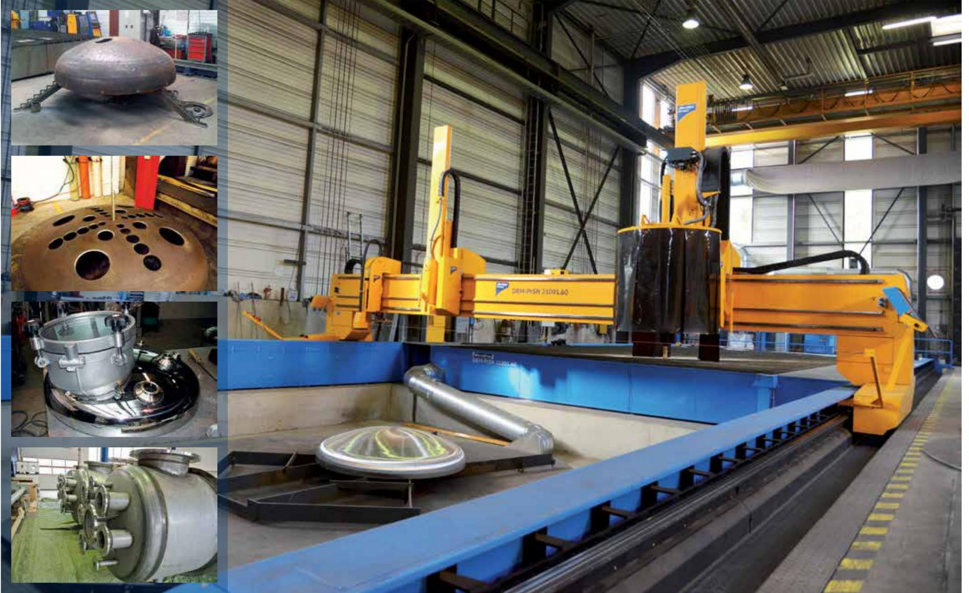
**D**RM-D es una máquina de corte CNC de alta resistencia diseñada para una amplia gama de aplicaciones de cúpulas, chapas y tubos. Su robusto pórtico permite operar sin vibraciones de maquinaria pesada como antorchas triples de oxicorte, un Rotator de 90° con una carrera de 1.500 mm en el eje Z, un Rotator de 120° para el corte de formas en 3D y otros equipos a medida. Junto
