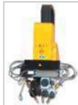
La antorcha triple de oxicorte con consola de gas totalmente automática permite realizar biselés complejos en V, Y y K con 3 antorchas de oxicorte de 20° a 50°. El ángulo y la distancia entre antorchas se puede establecer de modo manual o automático.
