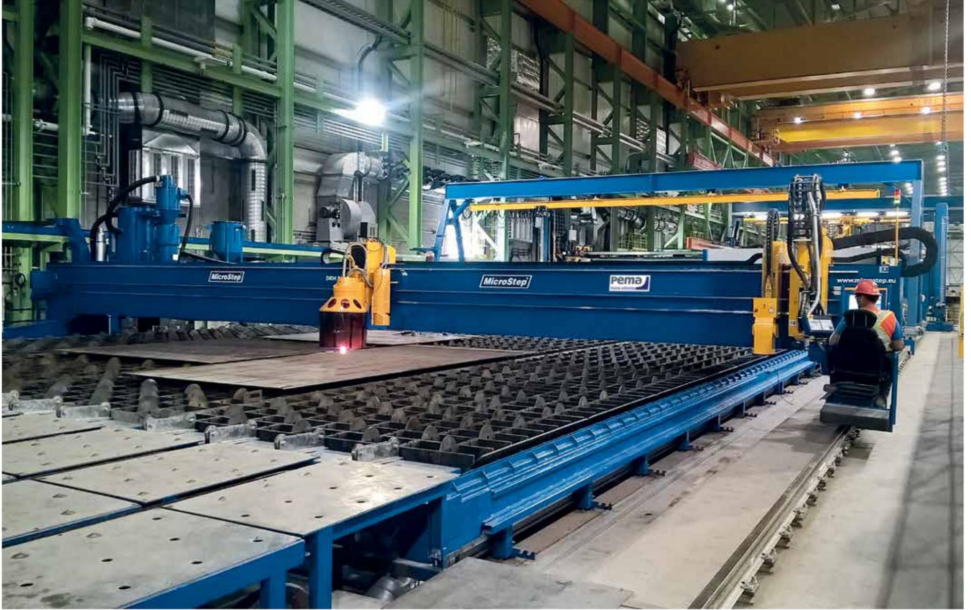
La DRM-PL está diseñada para cumplir con las exigencias de robustez del pórtico, grandes dimensiones de máquina y unos trabajos muy exigentes a realizar. Su robusto pórtico XXL permite una operación libre de vibraciones de equipos pesados, numerosos cabezales de biselado, oxicorte, mecanizado, soldadura, marcado, entre otros. La anchura de la DRM-PL puede ser más de 20 metros.
